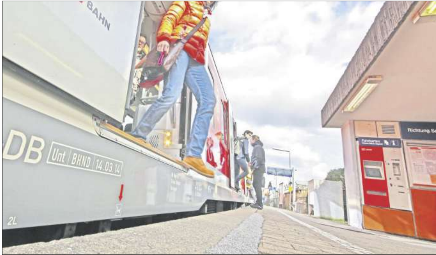
Wer nicht mehr gut zu Fuß ist oder mit Kinderwagen unterwegs ist, sollte am besten nicht an der Haltestelle Stetten-Beinstein einsteigen. Grund dafür ist die Bahnsteighöhe: Bedingt durch eine Kurve beträgt auf dem Bahnsteig in Fahrtrichtung Schorndorf die Höhendifferenz zum Zug zwischen 25 und 35 Zentimeter. Außerdem ist der Spalt, den es zu überwinden gilt, rund 26 Zentimeter breit. Bild: Habermann
